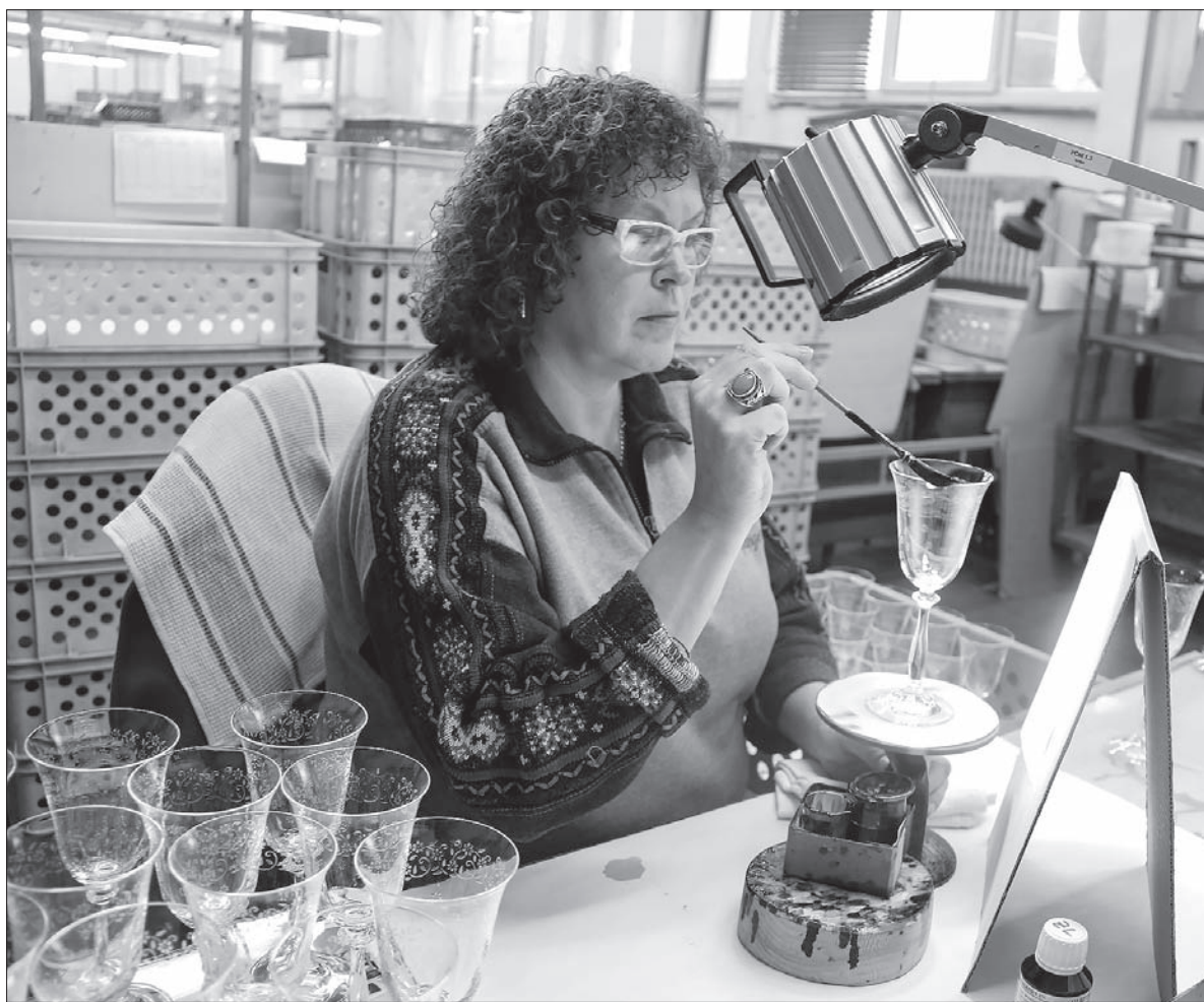
Pracownica zakładu maluje na kieliszkach złote obwódki.
