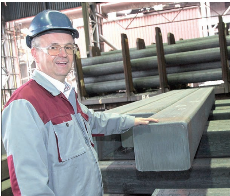
Te stalowe kęsiska wyszły właśnie z urządzenia do ciągłego odlewania.
